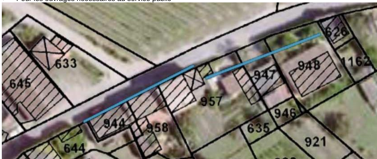
Illustration de la règle : en limite ou à 5m minimum
